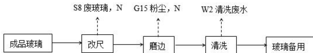
图 2-5 玻璃配件加工工艺流程及产污节点图
