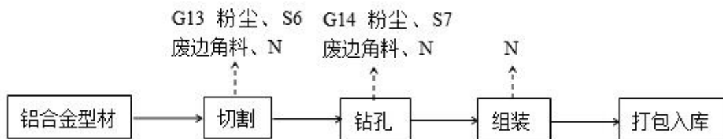
图 2-4 铝合金门窗生产工艺流程及产污节点图
