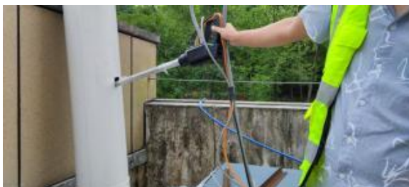
油烟废气进口采样照片（幼儿园）
